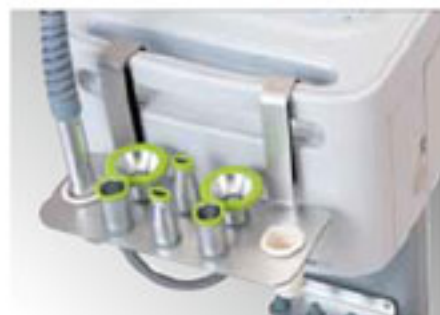
フック式先端ユニットホルダー 全てのユニットが収納できます。さらにプローブの一時置きスペースも確保しました。
